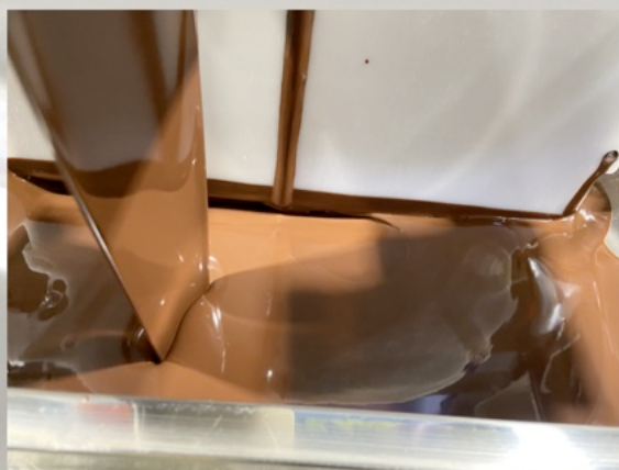
チョコレート円盤とコンベアが 非連動なので、 コンベアを付けずとも チョコレートの排出が可能です。
