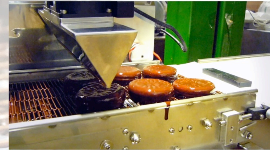
約10Kg容量のチョコレートタンク 加熱・保温はジャケット（湯煎式）です。
