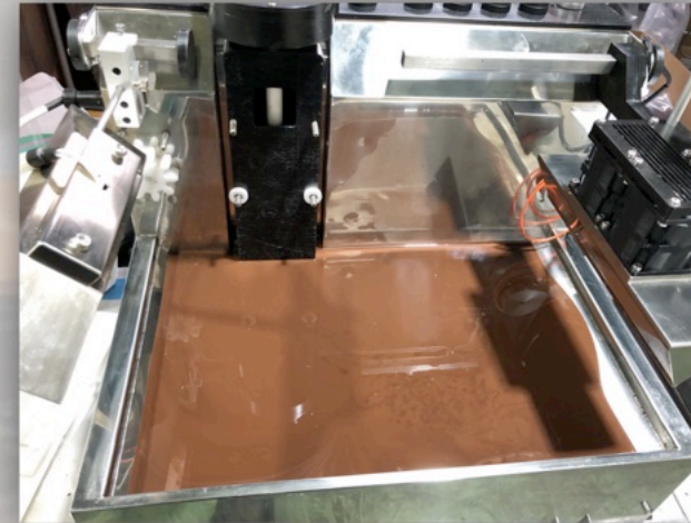
約10Kg容量のチョコレートタンク 加熱・保温はジャケット（湯煎式）です。
